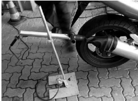
Figura II – Exemplo de extensão com sonda móvel e coifa flexível
